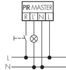
Mittels einem kurzen Tastendruck kann die Beleuchtung bei Bedarf manuell ein- bzw. ausgeschaltet werden (Achtung: Leuchtdrucktaster ohne Neutraleiteranschluss werden nicht unterstützt).
