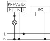
Bei Schaltung von netzparallelen Induktivitäten (Leuchtstofflampen, Schütze etc.) kann ein RC-Glied nötig sein.
