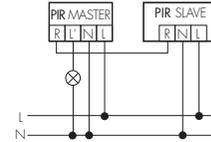
Vergrößerung des Bereiches mit einem bzw. mehreren Slave-Geräten. Achtung: Der Master muss immer an der dunkelsten Stelle montiert werden.
